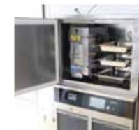
加熱処理した温かい食品を、一気に冷却します。細菌が活発に活動する温度帯を素速く通過させることができるので、大量調理において大きな役割を果たします。
