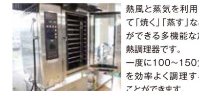
熱風と蒸気を利用して「焼く」「蒸す」などができる多機能な加熱調理器です。一度に100~150食を効率よく調理することができます。
